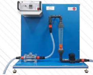
FME30. Transparent Vortex Flow Meter
