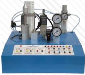
BS9. Pneumatic Test Module
