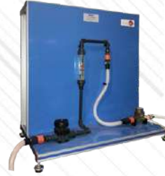
FME30/I. Vortex Flow Meter
